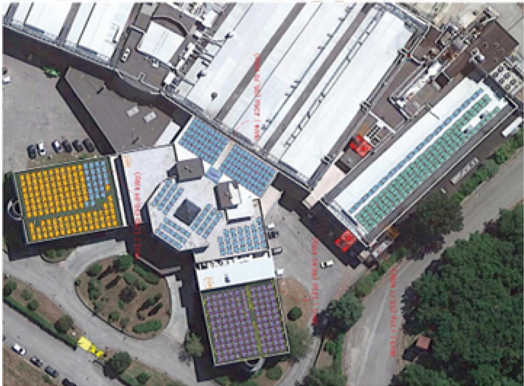
L'intervento realizzato è l'installazione di un impianto fotovoltaico sulla copertura dello stabilimento. Con questo intervento si vuole ridurre ulteriormente il prelievo di energia elettrica dalla rete e nello stesso tempo ridurre le emissioni di CO<sub>2</sub> nell'ambiente, essendo la produzione di energia da fotovoltaico del tipo rinnovabile.
